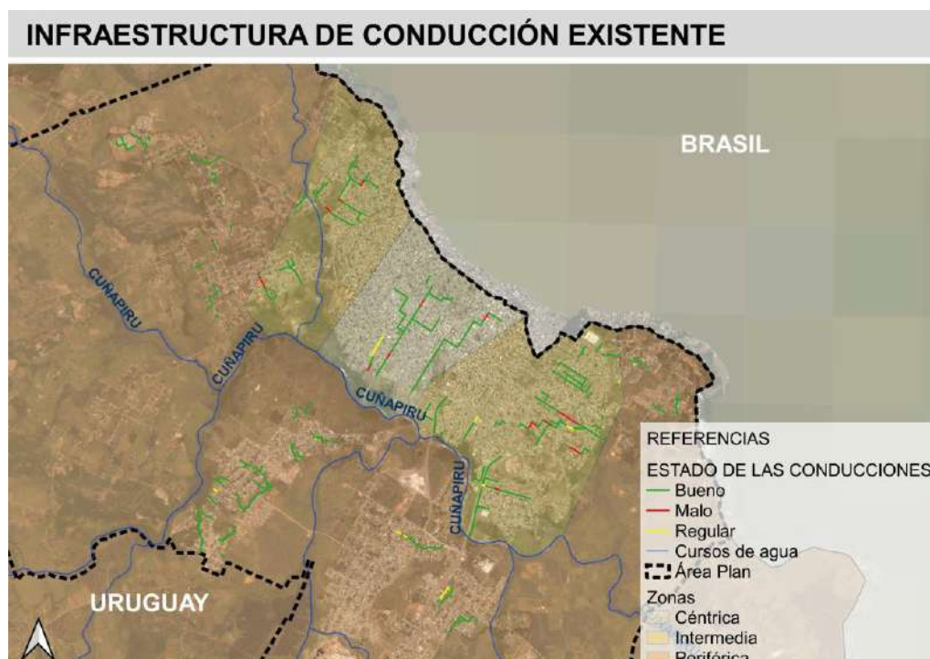
Figura 6 12. Zonas de la red pluvial según el estado de conservación y mantenimiento. Fuente: elaboración propia.
