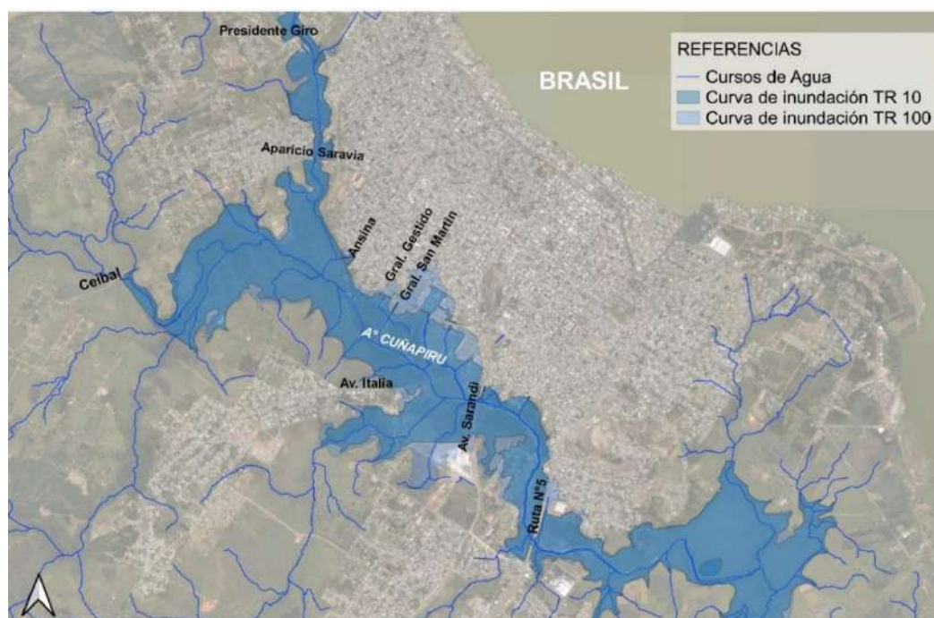
Figura 7 3. Curvas de inundación TR 10 y TR 100. Fuente: elaboración propia.
