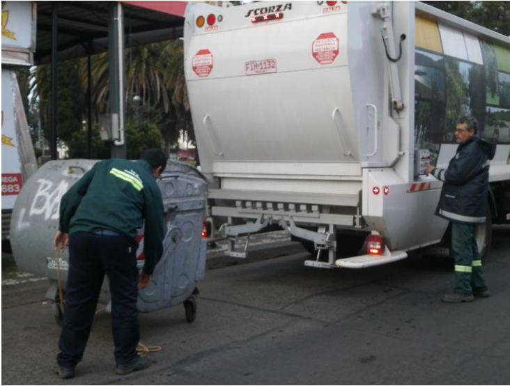
Lavacontenedor VW, con equipamiento lavacontenedor marca Scorza
