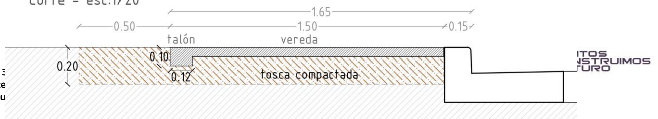
Detalle Vereda 1.50m Corte - esc:1/20
