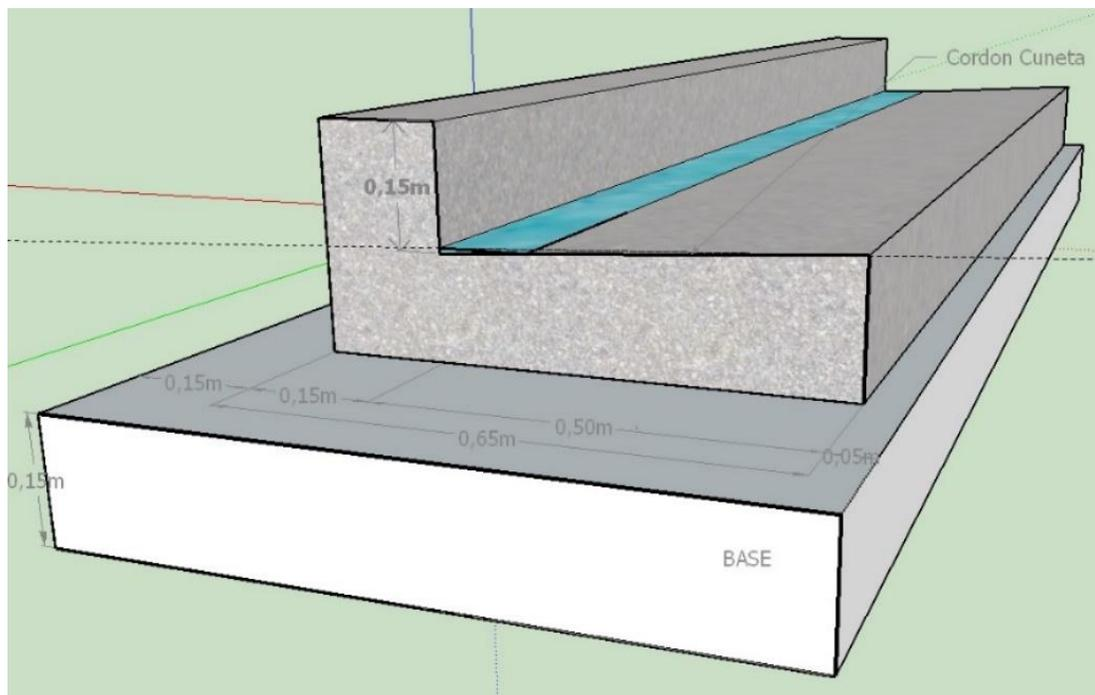
Figura 01: Detalle Típico Cordón Cuneta Sobre Base granular
