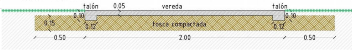
Detalle Vereda contra cordón 1.50m Corte - esc:1/20
