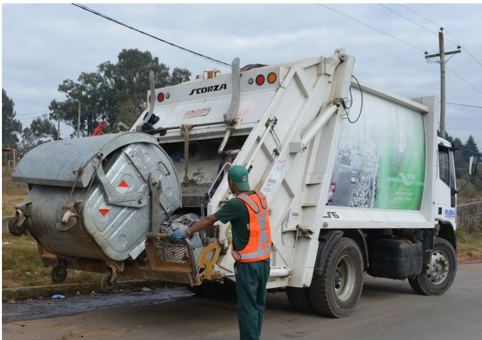
Camiones Volkswagen 17-280 Constellation, modelo "COMPACTOR" fabricado específicamente para recolección de residuos, caja automática "Allison", con carrocería RECOLECTOR DE RESIDUOS ALPHA 15M3, marca USIMECA.
